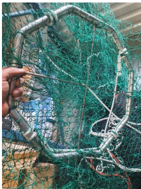
Fig 3. Sälgrinden i den första ingången till fiskhuset.
