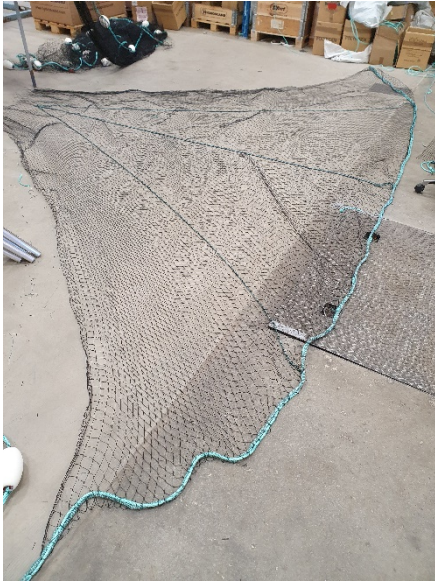
Fig 5. Mungarnets bottenduk med extra blytelnar monterade.
