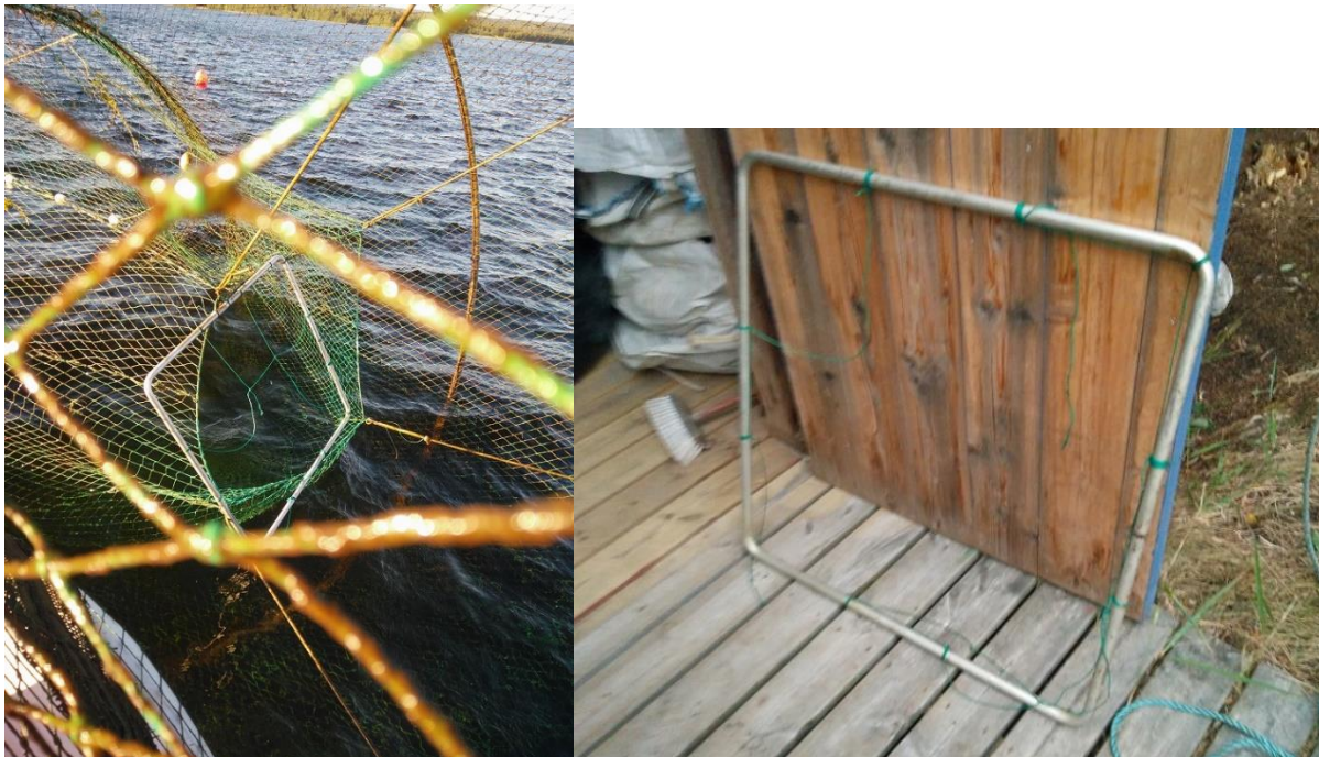
Figur 18. Åverkan på sälgrind med fyrkantmaska, som gjorts av säl. Första bilden är på sälgrinden på plats i ingången till vatthuset och andra bilden är med sälgrinden bortmonterad från fiskfällan. Foto Fredrik Bergman.
