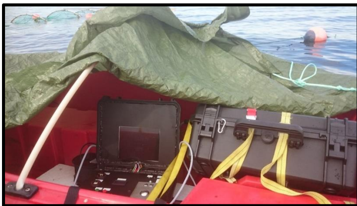
Figur 10. Inspelningsenhet (till vänster med öppet lock) och batteri enhet (till höger, med stängt lock och gula spännremmar).
