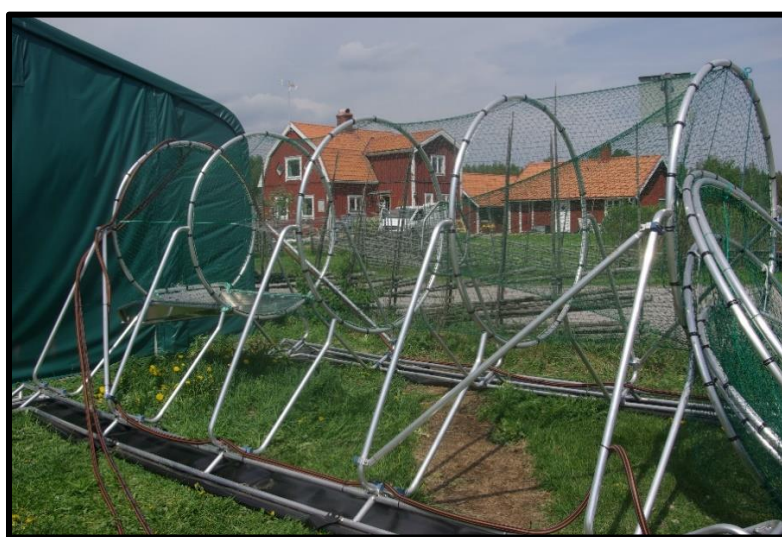
Figur 3. Fyrkantig selektionspanel i hela fiskhuset. Maskorna syns tydligast där himlen är bakgrund. Bergmanfällan utvecklades av Dennis och Anders Bergman i samråd med Harmångers Maskin & Marin.
