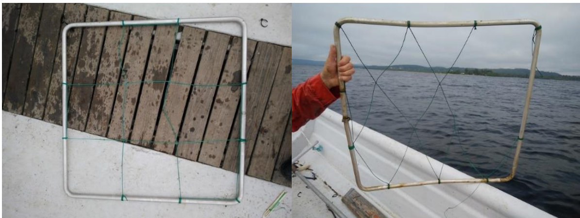
Figur 2. Sälskador på sälgrind. Fyrkantmaska på första bilden och diamantmaska på andra bilden. Foto Fredrik Bergman.
