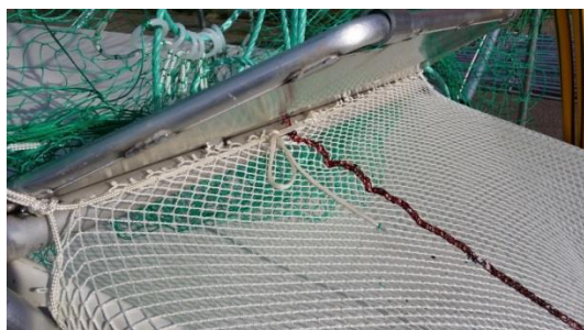
Figur 4. Vittjningspåsen monterad mot fiskhuset.
