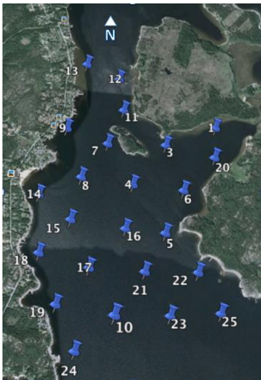
Figur 7. Nätverk av 25 hydrofoner (grid) inom vilket utsläppt lax kunde positioneras. Medelavståndet mellan hydrofonerna var 350 m. Bild: Google-earth.
